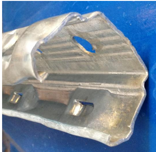
Profilo "Palo intermedio" con gancio a "esse": ricavato da nastri di acciaio zincato DX51D Z275. Asolato e forato. Possibilità di realizzazione anche in CORTEN S355J0WP e NERO S235JR.
