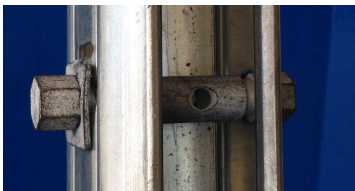
Profilo "Palo intermedio" con gancio a "esse": ricavato da nastri di acciaio zincato DX51D Z275. Asolato e forato. Possibilità di realizzazione anche in CORTEN S355J0WP e NERO S235JR.
